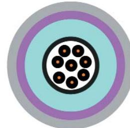
Поперечное сечение кабеля LANmark-OF UC
