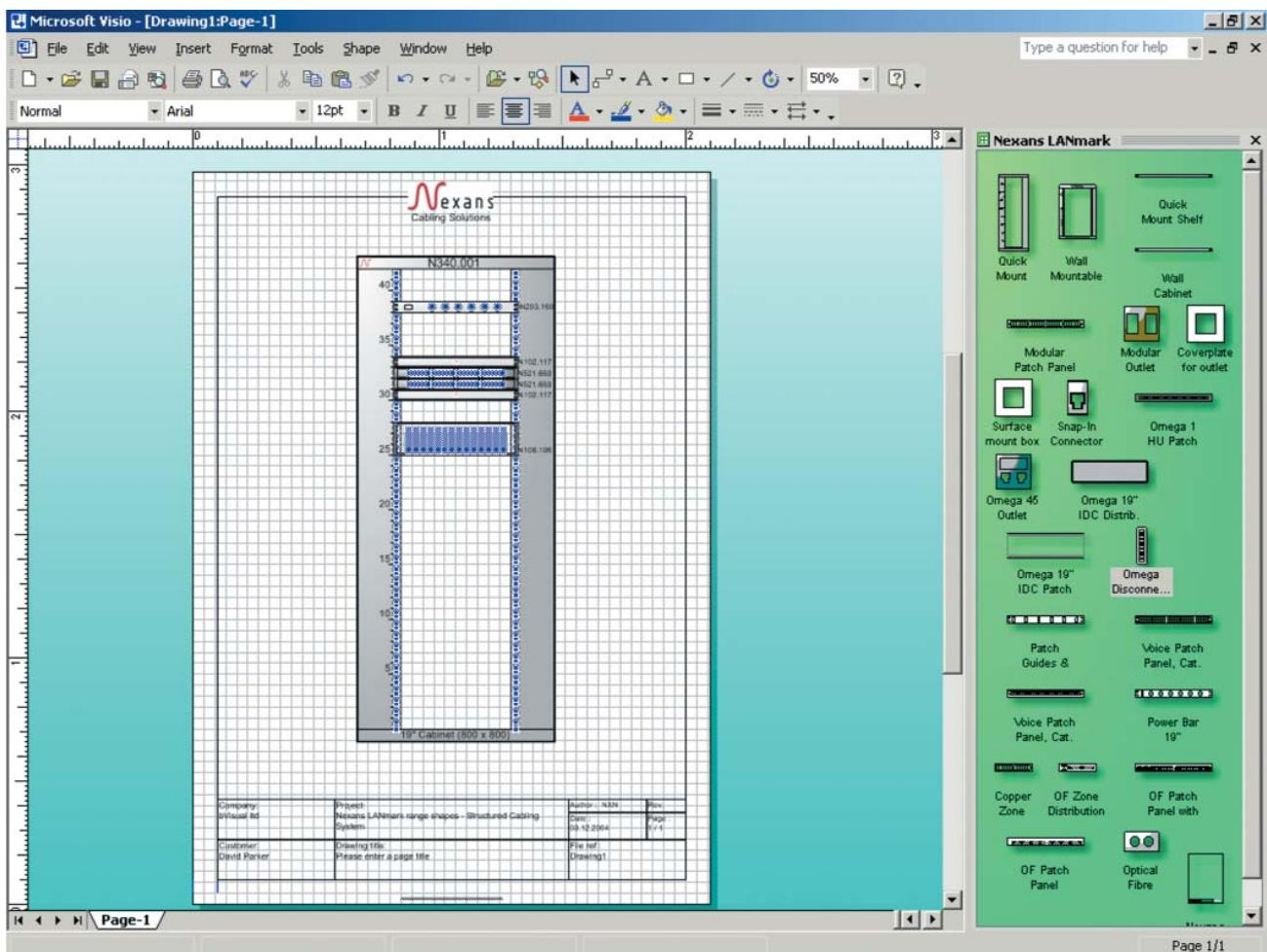
Для упрощения процесса проектирования структурированных кабельных систем компания Nexans Cabling Solution разработала библиотеку шаблонов для векторного редактора Microsoft Visio. Этот инструмент позволяет проектировщику достаточно оперативно выполнить компоновку телекоммуникационного распределительного шкафа, автоматически рассчитать полную спецификацию в соответствии с данной компоновкой и подготовить необходимые чертежи для общей проектной документации.
