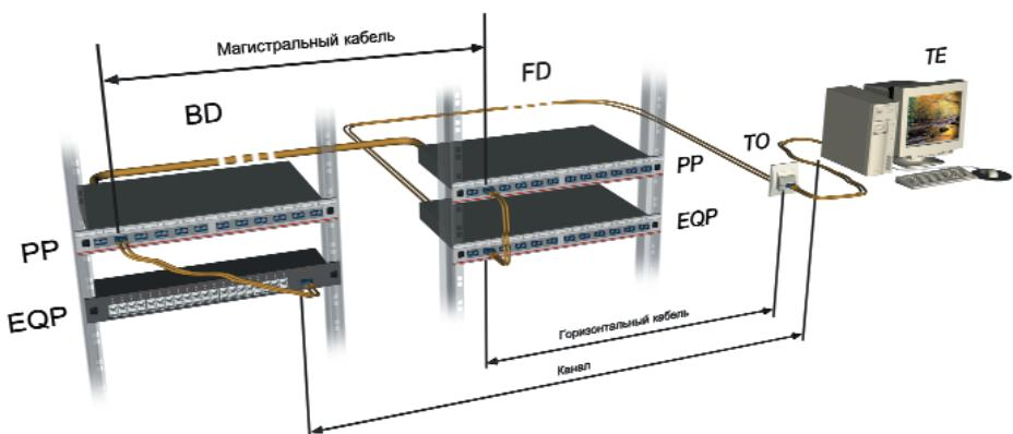
**a Схема коммутируемого объединенного канала.**
