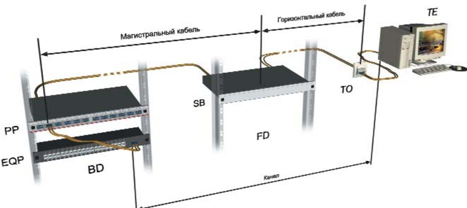
**b Схема некоммутируемого объединенного канала.**
