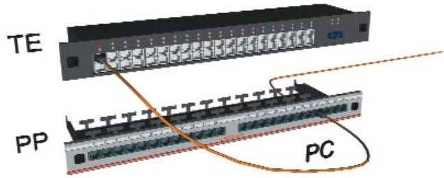
**Модель подключения inter-connect.**
