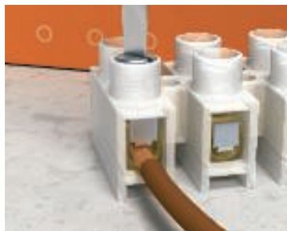
Гибкие тонкожильные провода Подключение тонкожильных проводов без гильзы для оконцевания жилы возможно с типом 74/D. Защитная проволочная скоба гарантирует контакт по всей поверхности тонких медных жил.
