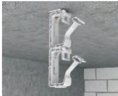
Присоединение в ряд друг под другом Несколько групповых креплений-захватов можно соединять рядами друг над другом. В зависимости от нагрузки и крепления не допускается соединять рядами друг над другом более двух групповых креплений-захватов ОВО.
