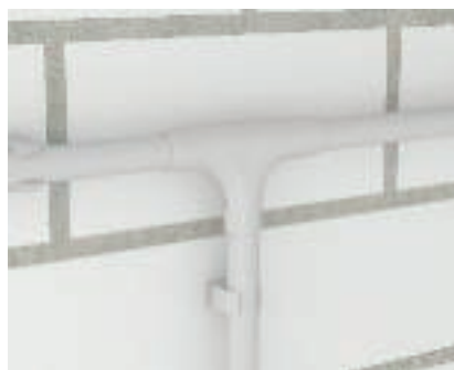
Готовый монтаж, Т-образная секция После защелкивания передней части монтаж завершен. Угловая секция может легко открываться с помощью отвертки.
