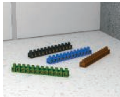
Применение ответвительных клеммных зажимов DoIü У ответвительного клеммного зажима DoIü отдельные клеммы возможно отсоединить. Для различных цветов жил имеются цветные клеммы, таким образом цветное сквозное подключение не представляет никаких проблем.
