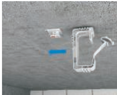
Крепление группового крепления-захвата Групповое крепление-захват надвинуть на предварительно отсоединенный крепежный элемент.
