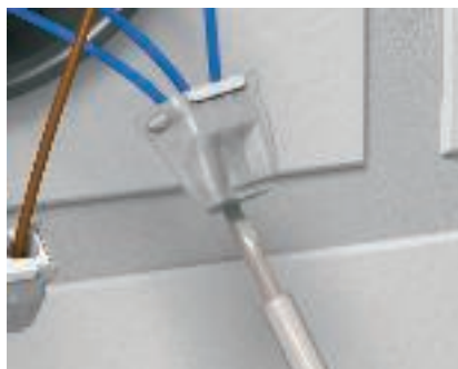
Контрольное отверстие Практично и надежно: благодаря контрольному отверстию на обратной стороне можно измерить и проверить жилу диагностическим штифтом или фазовым индикатором (макс. Ø 2 мм).
