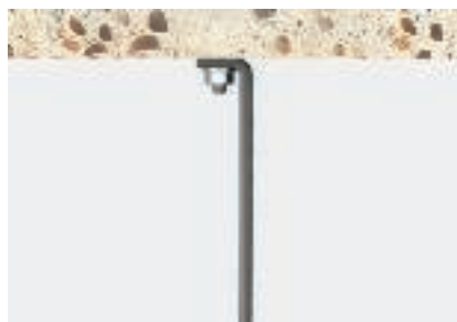
Вариант нагрузки 4: прикручен винтом с шайбой под потолком Допустимая нагрузка С
