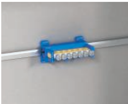
Применение клемм нулевого провода Клемма нулевого и защитного провода может быть установлена по горизонтали на плоском профиле 0 10 x 2,5 мм.
