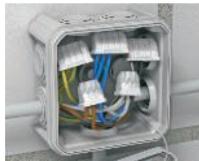
Пружинный клеммный зажим в распределительных коробках Также для соединения кабелей/проводов внутри распределительных коробок подходят клеммные зажимы. С клеммными зажимами OBO можно соединять провода сечением от 0,75 мм 2 до 2,5 мм 2 в одном типе клемм.
