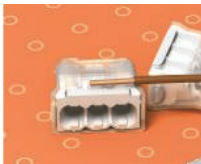
Отрезать по длине жилы Маркировка на вставной клемме показывает правильную длину удаления изоляции. Это обеспечивает не только точную посадку жил, но и максимальную надежность контакта. Благодаря прозрачному окошку можно визуально проверить правильность посадки жил.
