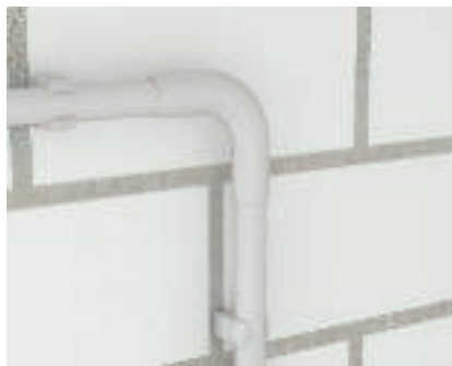
Готовый монтаж, угловая секция Quick-Pipe После защелкивания передней части монтаж завершен. Т-образная секция может легко открываться с помощью отвертки.
