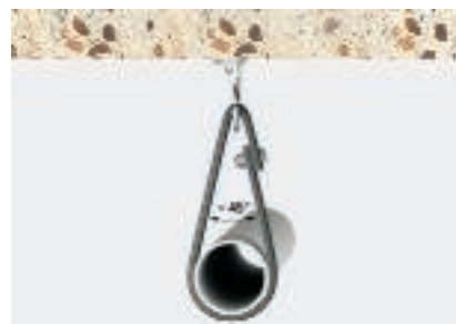
Вариант нагрузки 6: лента обвязана вокруг плоской проушины и трубы или вокруг подобного Допустимая нагрузка 2xB
