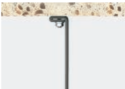
Вариант нагрузки 5: прикручен винтом под потолком, концы ленты двойные, свободный конец вниз Допустимая нагрузка В
