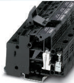
16 (25) мм 2 , 32 А, клеммы с держателем предохранителя рычажного типа для плавкого предохранителя 10,3 x 38 мм
