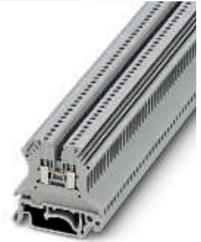
1,5 (1,5) мм 2 , 17,5 А, проходная клемма
