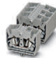
2,5 (4) мм 2 , 30 А, проходная клемма, 4 контакта, с защёлкой на панель
