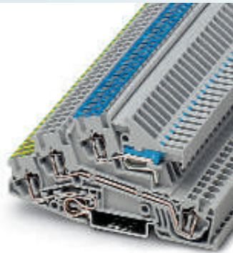
2,5 (4) мм 2 , 20 А, трехъярусная клемма, 1 х фазовый провод L, разъединяемый 1 х N-провод, 1 х заземляющий провод
