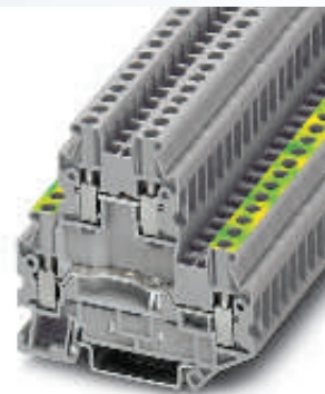
2,5 (4) мм 2 , 28 А, двухъярусная заземляющая клемма
