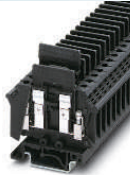
4 (4) мм 2 , 6,3 А, клемма для установки предохранителя 5 x 20 мм и 5 x 25 мм
