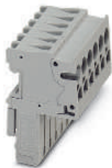
2,5 (4) мм 2 , 24 А, штекер, подключение перпендикулярное
