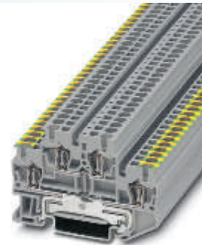
2,5 (4) мм 2 , 32 А, двухъярусная клемма, нижний ярус с заземлением
