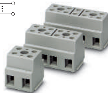
10 (16) мм 2 , 76 А, блок клемм, многоконтактный
