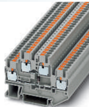
2,5 (4) мм 2 , 26 А, диодная двухъярусная клемма
