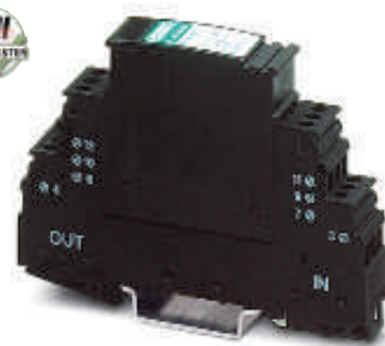
Вставной разрядник с винтовыми зажимами, для пяти проводников, с общим опорным потенциалом
