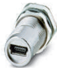
Mini-B USB, крепежная резьба M12, контакты для пайки волной припоя, встроенный контакт для экранирования
