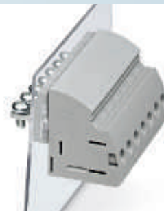
Проходная клемма 16/25 мм 2 , герметизируемая заливкой, вертикальное подключение провода, винтовой разъем M5
