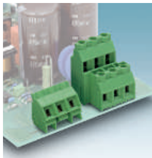
Серия MKDS 5: винтовые зажимы, до 32 А, шаг выводов 6,35 мм / 7,62 мм / 9,52 мм MKDS(V) 5/... со стр. 363
