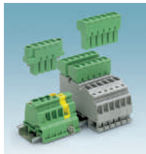
Серия PC 4: возможность установки на монтажную рейку, до 20 А, шаг выводов 7,62 мм PCVK 4/... стр. 427
