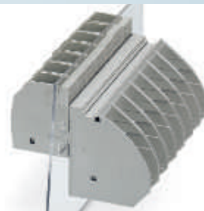
Сильноточная проходная клемма 35 мм 2 , герметизируемая заливкой, вертикальное подключение провода, внутренняя часть с болтовым разъемом M8
