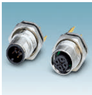
Встраиваемые соединители M12 для монтажа на печатные платы, пайка волной припоя, с контактом для экранирования со стр. 733
