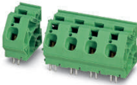
Шаг 15 мм, с контрольным отводом, возможность установки перемычек, UL-допуск на применение в цепях с напряжением 600 В
