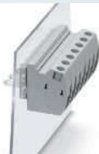
Проходная клемма 10/16 мм 2 , герметизируемая заливкой, горизонтальное подключение провода, внутренняя часть с выводами под пайку
