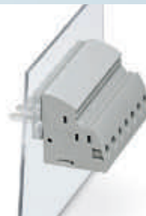
Проходная клемма 10/16 мм 2 , герметизируемая заливкой, вертикальное подключение провода, внутренняя часть с выводами под пайку
