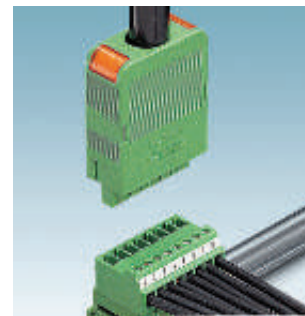
Корпуса кабельного разъема, для штекерных частей с винтовыми зажимами, количество полюсов от 2 до 16, шаг выводов 3,81 мм KGG-MC 1,5/... стр. 228
