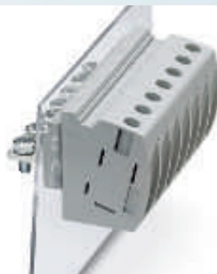
Проходная клемма 25/35 мм 2 , герметизируемая заливкой, горизонтальное подключение провода, винтовой разъем M6
