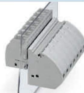
Сильноточная проходная клемма 16 мм 2 , герметизируемая заливкой, вертикальное подключение провода, внутренняя часть с болтовым разъемом M5
