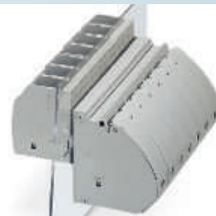
Сильноточная проходная клемма 35 мм 2 , герметизируемая заливкой, вертикальное подключение провода, внутренняя часть с болтовым разъемом M8
