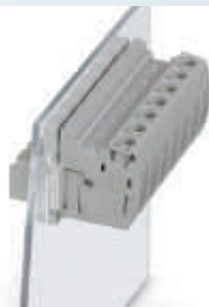
Проходные клеммы 4/6 мм 2 , герметизируемые заливкой, горизонтальное подключение провода, внутренняя часть с плоским штекером
