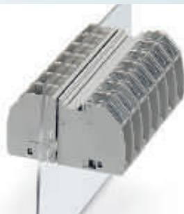
Проходная клемма 16 мм 2 , герметизируемая заливкой, горизонтальное подключение провода, внутренняя часть с болтовым разъемом M5
