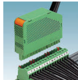
Корпуса кабельных разъемов, для штекерных частей с винтовыми зажимами, от 2 до 24 полюсов, шаг выводов 5,0 / 5,08 / 7,5 / 7,62 мм стр. 320
