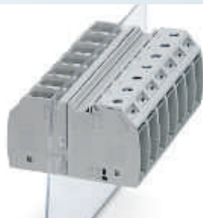
Сильноточная проходная клемма 35 мм 2 , герметизируемая заливкой, горизонтальное подключение провода, внутренняя часть с болтовым разъемом M8
