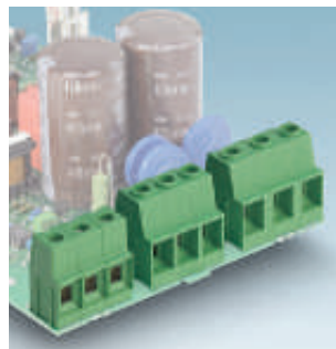
Серия MKDS 10: винтовые зажимы, до 76 А, шаг выводов 10,16 / 12,7 мм MKDS(V) 10/... со стр. 371
