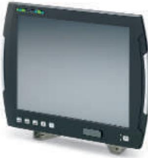
Панельный ПК со степенью защиты IP65 и дисплеем 30,7 см (12,1")
