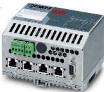
Прокси-сервер PROFINET-PROFIBUS для систем управления PC WORX
