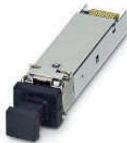
Модули SFP для передачи сигналов на расстояние до 80 км
