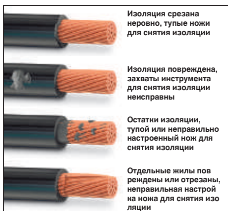
Ошибки снятия изоляции по DIN МЭК 60352
