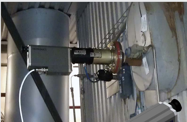
IR-pyrometer för gastemperatur.
