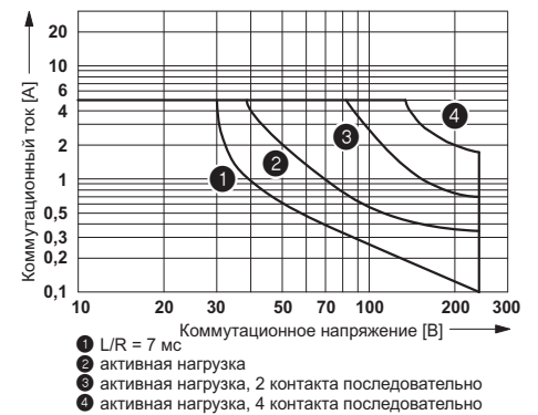
Мощность отключения постоянного напряжения
