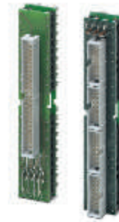
Фронтальный адаптер для SIMATIC® S7-300 Платы ввода-вывода с макс. 32-ю каналами
