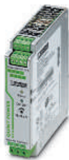
Источник питания, однофазный, 24 В пост. тока, 3,5 А
