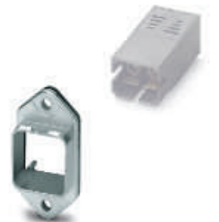
Монтажная панель соединителя SCRJ, исполнение 14, для кабелей на основе полимерного волокна HCS 980/1000 мкм
