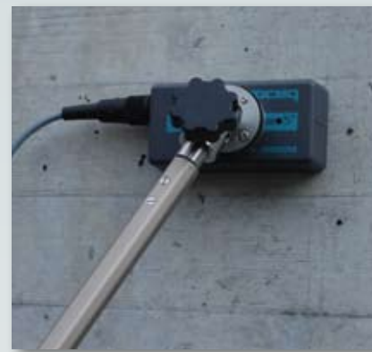
Телескопическая штанга для универсального датчика или тележки ScanCar
