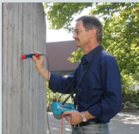
Измерения с помощью стержневого электрода в соответствии со стандартами.
