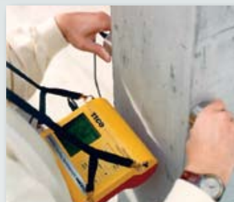
Непрямое или поверхностное прозвучивание
