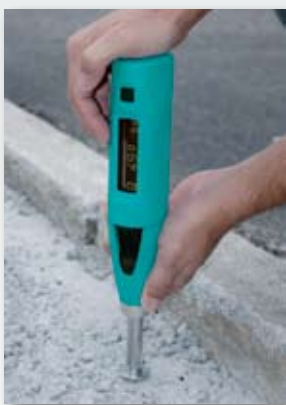
... на легком бетоне (с грибовидным плунжером)
