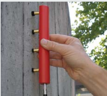
Четырехточечный датчик Веннера
