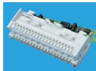
Съемный вставляемый с тыльной стороны модуль для ленточного кабеля или специальных цепей
