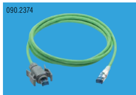
090.2374 Шнур переключения Real10 Cat.6, S/FTP, 4P, PUR, RJ45/s IP67 type 06-RJ45/s IP20, 2.5 m Артикул - R313637
