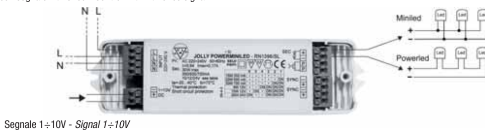
Fig. 3 - Comando con segnale 1÷10Vcc - Control with 1÷10Vcc signal
