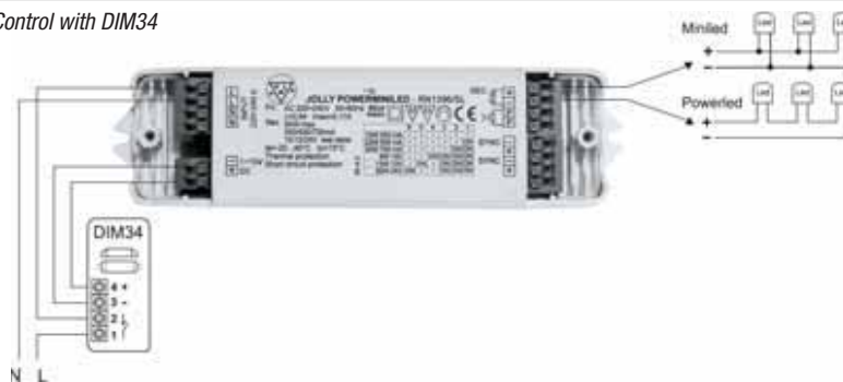
Fig. 3 - Comando con segnale 1÷10Vcc - Control with 1÷10Vcc signal
