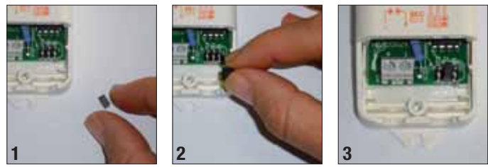
Fornito di JUMPER per la selezione della tensione in uscita Provided JUMPER to select the output voltage
