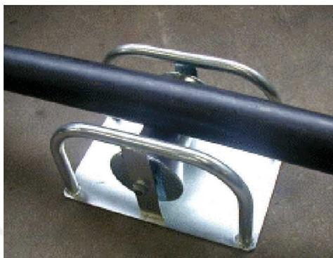
**ПРИМЕР.** Ролик одножильного кабеля и движение кабеля через него на прямом участке
