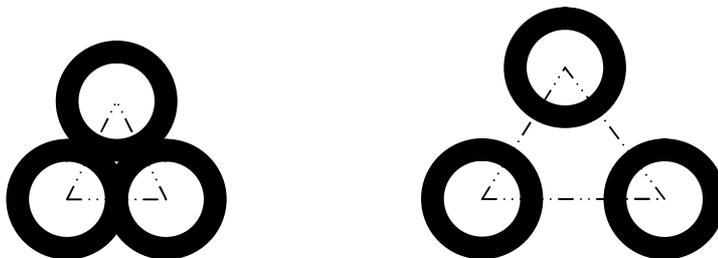
**ПРИМЕР.** Стандартная схема симметричных прокладок треугольником
