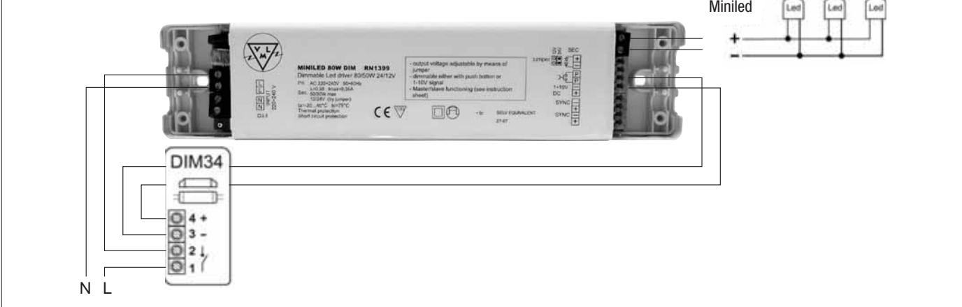
Fig. 3 - Comando con segnale 1÷10Vcc - Control with 1÷10Vcc signal
