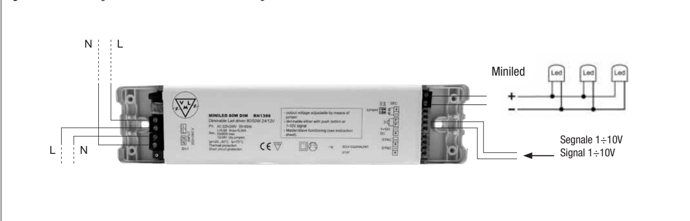
Fig. 3 - Comando con segnale 1÷10Vcc - Control with 1÷10Vcc signal
