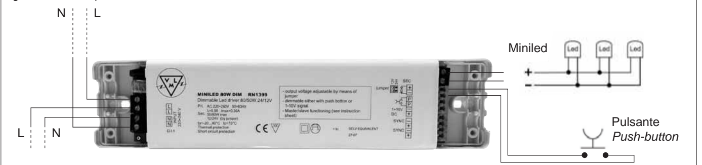
Fig. 1 - Comando con pulsante - Push-button control
