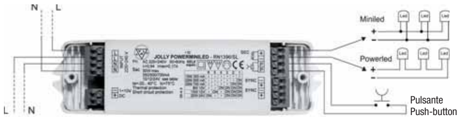
Fig. 1 - Comando con pulsante - Push-button control
