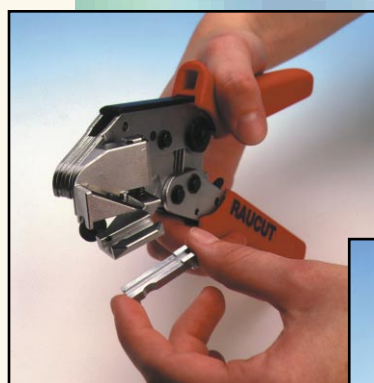
Einsetzen der Aderführung Insertion of multifibre buffer tube guide
