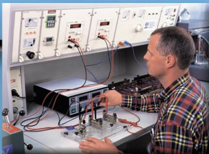
Elektrische Prüfung von Crimpverbindungen Electrical testing of crimp connections
