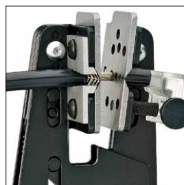
Abisolieren durch Formmesser Stripping with profile blades
