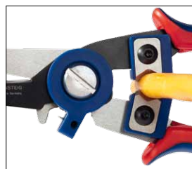
Abmanteln des Außenmantels mittels austauschbarem Formmesser
