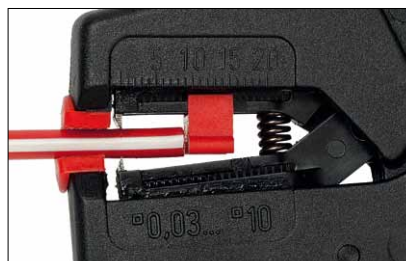
Art. No. 707 001 Querschnittsbereich 0,03–10 mm 2 Cross-section range 0.03–10 mm 2
