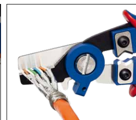
Schneiden der Innenleiter Cutting the conductors
