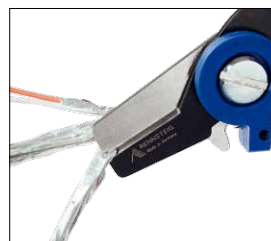
Schneiden der Paarschirmung Cutting the double shielding
