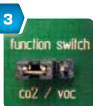
3 Переключатель рабочих режимов выборочное реле для CO 2 или VOC
