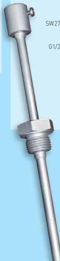
TH 08- VA / xx / 90 Гильза погружная из высококачественной стали с горловиной
