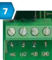
7 Винтовые зажимы активные выходные сигналы 0-10В, 4...20мА или коммутационные выходы
