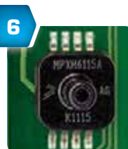
6 Барометрическая компенсация давления воздуха при измерении CO 2
