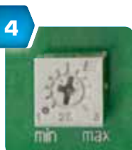
4 Потенциометр для настройки порога переключения реле
