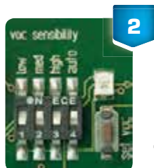
2 Кнопка Set для VOC для ручной калибровки
