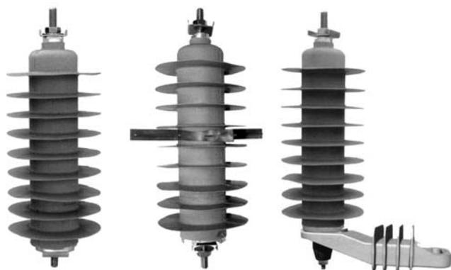
Ограничители перенапряжений (ОПН), предназначенные для защиты воздушных линий электропередачи от грозовых и коммутационных перенапряжений, представляют собой комплект оксидноцинковых (ZnO) варисторов, заключенных в высокопрочный герметичный силиконовый корпус.
