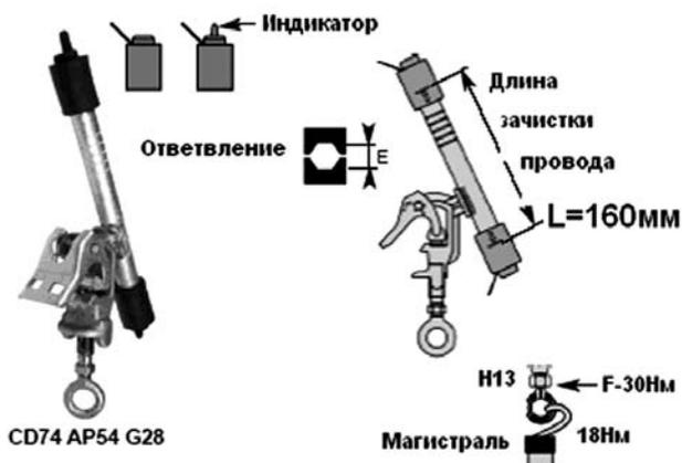
Каждая оконечность снабжена герметичной прокладкой, а также съемной заглушкой с индикатором наличия и правильности положения провода в гнезде ответвления, который сжимается, если провод занял неправильное положение - тем самым обеспечивается повышенная безопасность.
