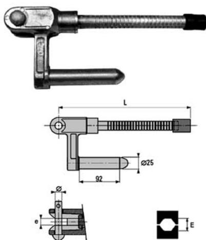
Служат для крепления на анкерных опорах защищенных проводов с толщиной изоляции от 1,5 до 3мм. Провод крепится в зажиме прессованием ручным прессом с шестигранными матрицами.
