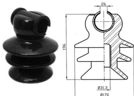
Линейный штыревой фарфоровый изолятор используется для крепления провода СИП-3 на ВЛ напряжением до 20 кВ. Пластмассовая втулка в верхней части изолятора позволяет обходиться без монтажных роликов. После растяжки линии провод крепится в желобе или на шейке изолятора. Диаметр шейки 85 мм.
