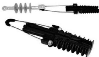
Анкерные клиновые зажимы для подвески на анкерных опорах защищенных проводов сечением от 35 до 70 мм<sup>2</sup> с толщиной изоляционной оболочки 1,5 - 3 мм.
