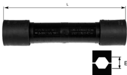
Соединительные гильзы MJPT...G 28/G 45 служат для герметичного соединения проводов из алюминия или из алюминиевого сплава сечением 35-185 мм<sup>2</sup>. Соединительный элемент гильз выполнен из алюминиевого сплава. Монтаж гильзы осуществляется опрессовкой шестигранными матрицами с помощью прессы HVD 50 CP.
