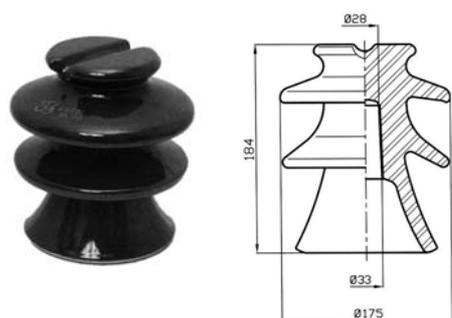
Линейный штыревой фарфоровый изолятор используется на ВЛ напряжением до 20 кВ. Монтируется на стандартном штыре. Провод закрепляется в желобе или на шейке изолятора. Диаметр шейки 85 мм.
