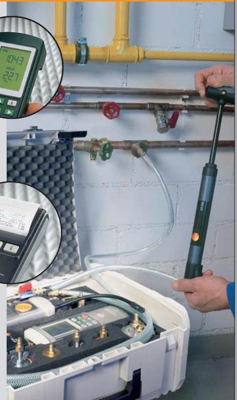
Измерение давления в гидравлических системах (3-5 бар тестирующее давление)
