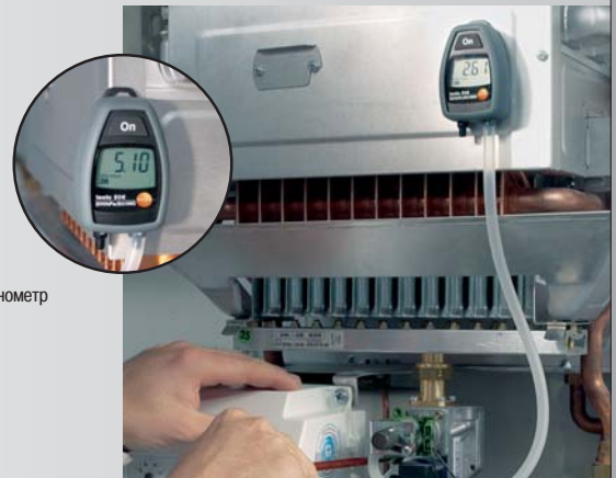
Переключаемый диапазон измерений; измерение давления газов и тяги
