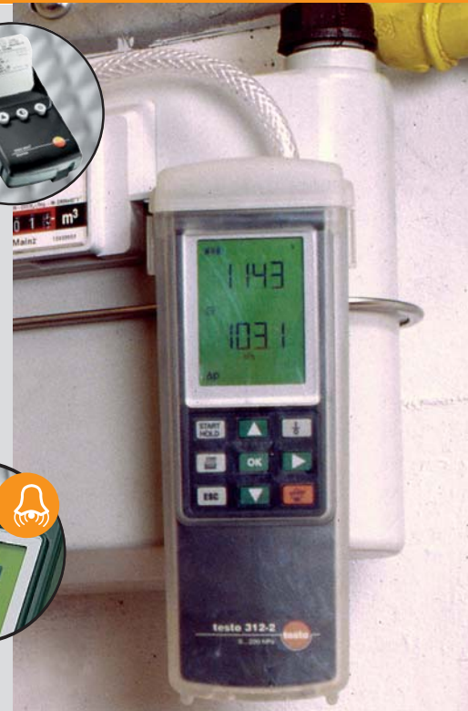
Измерение дифференциального давления на отопительных агрегатах
