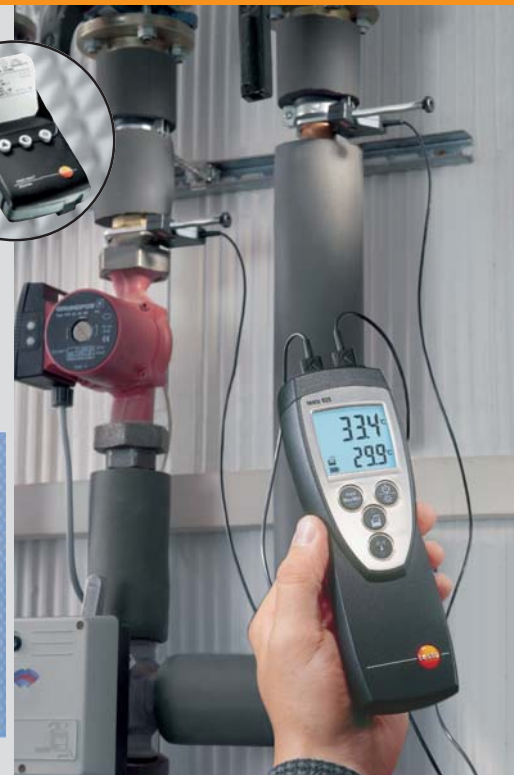
Измерения дифференциальной температуры (подающая/обратная линии)
