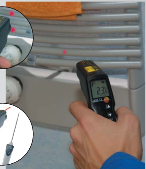
Проверка температуры в отопительных системах
