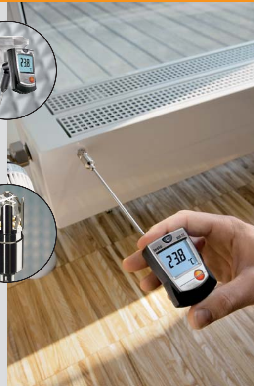
Измерение температуры поверхностей, напр. радиаторов
