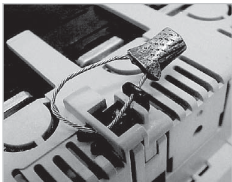
Блокировка клеммной крышки свинцовой пломбой
