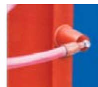
Ввод ВН. Обслуживание сводится к простому осмотру, проверке соединений и термодатчиков
