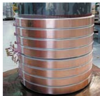
Обмотка ВН изготовлена из алюминия
