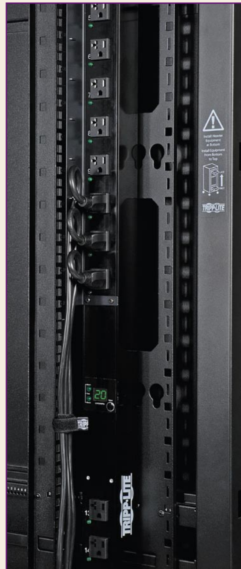
Instalación sin herramientas de una PDU de Tripp Lite. Cada riel para montaje sin herramientas puede acomodar dos PDU o administradores de cables de lado a lado (cuatro en total por rack o rack de bastidor abierto).
