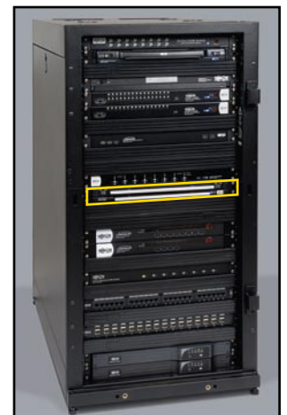
Las consolas de rack se pliegan como una laptop y se deslizan dentro de una gaveta de rack 1U.
