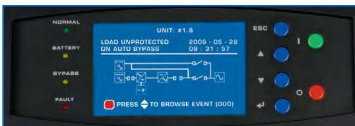
ЖК или светодиодная панель управления предоставляет подробную информацию о состоянии ИБП.
