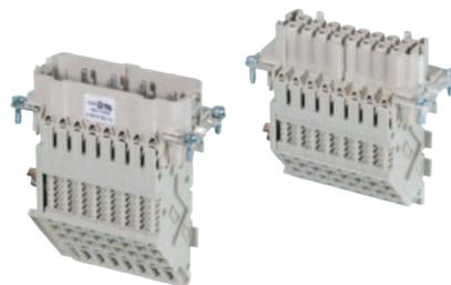
Клеммные адаптеры этой серии совместимы по контактам с контактными вставками на 690/400 В, которые приведены на стр. 1070. Применение этих клеммных адаптеров понижает расчетное напряжение штекерного соединения до 500 В.
