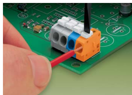
Подключение/отключение тонкопроволочных проводников: Откройте зажим клеммы нажав на рычаг и вставьте проводник в клемму до упора
