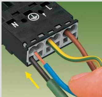
Откройте клеммные зажимы, используя отвёртку (2.5 x 0.4) мм, и вставьте зачищенный проводник до упора
