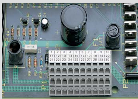
Экономия места при использовании трёхуровневых клемм
