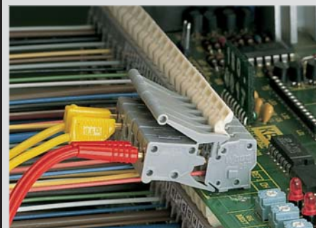
Тестирование с помощью тестового адаптера
