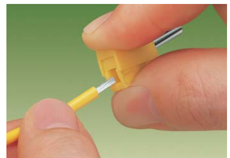
Подключение проводника: Нажмите кнопку и до отказа вставьте проводник. Отпустите кнопку для фиксации проводника.
