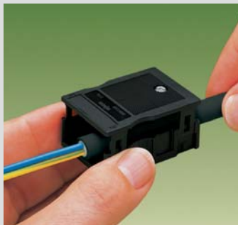
Перед подключением проводников, проденьте кабель через кабельный фиксатор (корпус штеккера)
