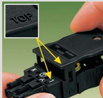
Вставьте разъем в кабельный фиксатор. Совместите метки верхней позиции "TOP"
