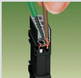
Откройте клеммные зажимы, используя отвёртку (2.5 x 0.4) мм, и вставьте проводник до упора
