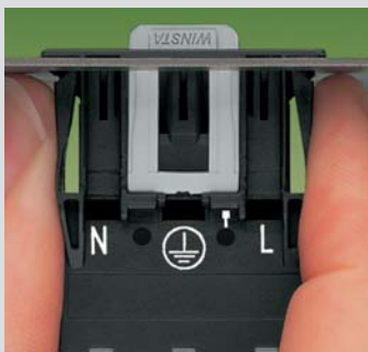
Выньте панельный ввод изнутри корпуса, нажав на фиксаторы сбоку штеккера
