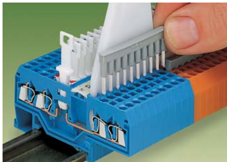
Объединение клемм с фронтальным вводом с помощью 10-контактной перемычки типа "гребень" при помощи специального инструмента
