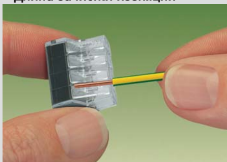
Одножильный проводник: изоляцию снять на длине 12 мм
