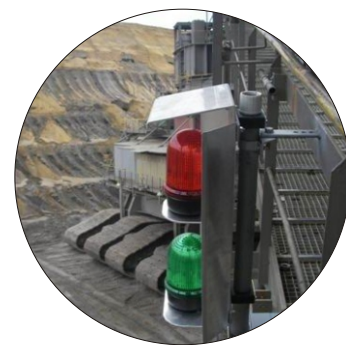
Сигнализация на колесно-лопастном экскаваторе в карьере компании RWЕ: Светодиодная сигнальная лампа кругового свечения 280
