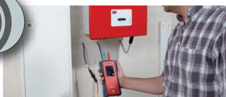
Drahtlose Übertragung der Messwerte vom „SENSOR“ auf den „ANALYZER“.
