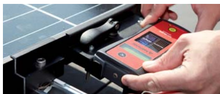
„SENSOR“ in einer Ebene mit Modulen montieren und die Einstrahlung messen.
