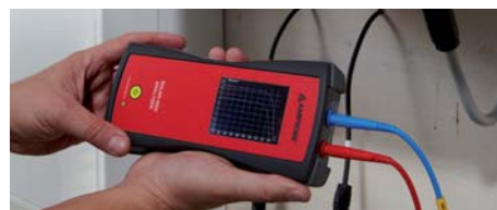
Mit dem „ANALYZER“ Leerlaufspannung und Kurzschlussstrom messen und Strom-/Spannungskennlinie der Anlage ermitteln.
