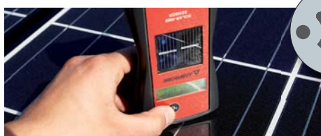
Erneute Messung der Oberflächentemperatur mit dem „SENSOR“.
