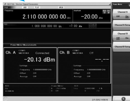
Power Meter Function
