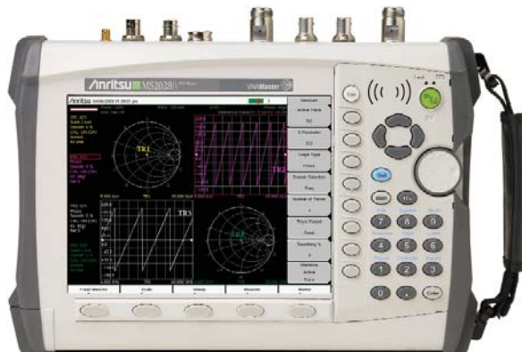
MS2026/28B анализатор VNA Master™
