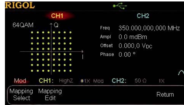
Формирование сигнала созвездия (QAM64)
