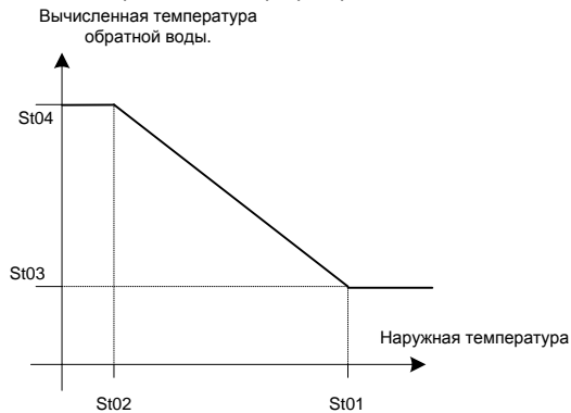
Вычисление температуры обратной воды, необходимой для запуска установки.
