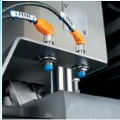
IME Определение положения на упаковочной установке
