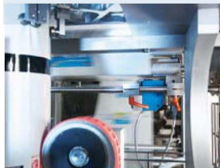
Датчик контраста KT5-2 от SICK используется для обнаружения маркировки
