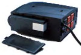
Встроенные батареи можно легко заменять в «горячем режиме». Они дают возможность работать в автономном режиме более 10 минут для типичных нагрузок (70 % и менее) и около 5 минут при 100 % нагрузке. В комплект поставки ИБП **PowerSure PSA** входит бесплатное ПО Multilink, позволяющее контролировать состояние ИБП, а также осуществлять корректное отключение критичной нагрузки в случае длительного отсутствия сетевого напряжения.
