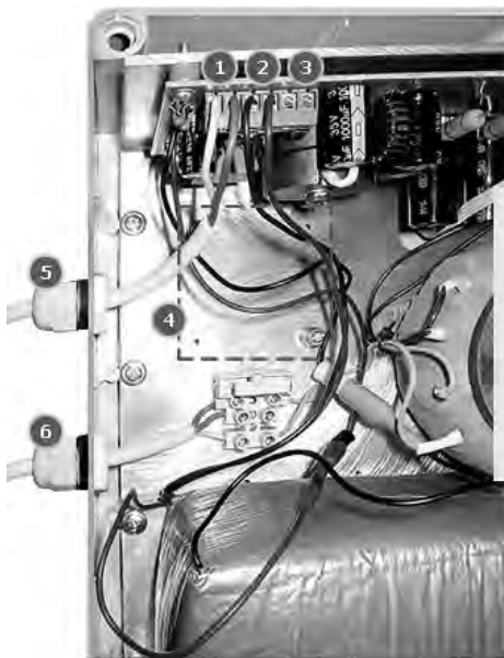
СКАТ-1200 исп.5 1 - выход 12В 2 - подключение обогрева 3 - клеммы подключения дистанционной индикации перехода на резерв 4 - места крепления дополнительного оборудования Герметичные вводы: 5 - выход на нагрузку 12В 6 - вход ~220В
