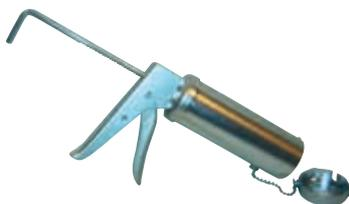
При монтаже требуется специальный инструмент – пистолет-шприц для нагнетания компаунда под давлением Е-4
