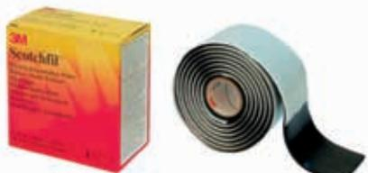
Электроизоляционная мастика толщиной 3,18 мм для изоляции и защиты от влаги, выравнивания поверхностей в местах соединений кабеля, заполнения неровностей и пустот с целью получения ровной основы для последующей намотки изоляционной ленты. Легко поддается формовке даже при низких температурах. Сохраняет эластичность и устойчивость к атмосферным воздействиям в течение длительного времени.
