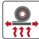
Изоляция на подвижных (включая необходимость гибкости) прямых и гладких токоведущих частях, подверженных вибрации и сильному абразивному воздействию
