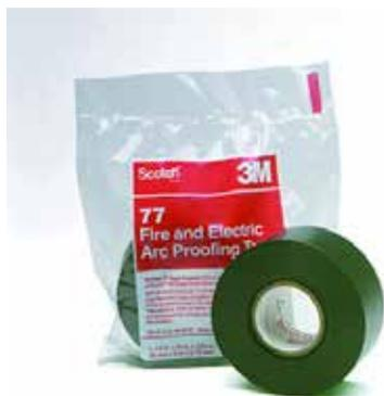
Самозатухающая лента для защиты оболочки кабеля от огня и дугового разряда. Под воздействием высокой температуры лента утолщается, образуя непроводящий защитный слой. Не содержит клеевого слоя. Пластичность ленты Scotch® 77 позволяет производить обмотку кабеля и арматуры неправильной формы.
