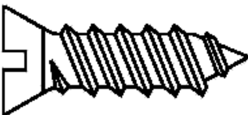
Рисунок 1 — Самонарезающий формирующий винт (3.6.10)
