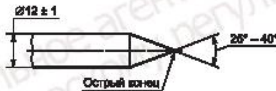
б) Разрядный наконечник для испытания методом контактного разряда
