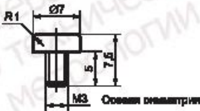
Верхняя часть центрального проводника. Нержавеющая сталь. Приблизительно 2:1
