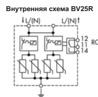
Внутренняя схема BV25 Внутренняя схема BV25R BV 25-275* BVR 25-275* варистор
