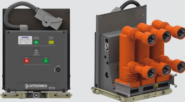
Выключатель вакуумный VF12 оснащен пружинным приводом с механическим накоплением энергии. Привод может быть введен вручную или с помощью двигателя с редуктором.
