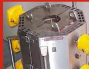
Печь моноблок 3 зоны АТЕХ взрывозащищенная 1,5 кВт
