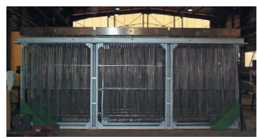
От -40° C до 20° C сборка канального воздухоосушителя -EХе - 6 x 2 м2 площадь теплообмена – Мощность 240 кВт
