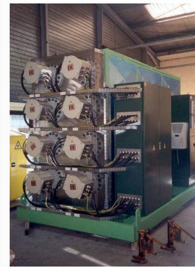
2000 кВт, 415 В 3 фазы. Жидкость: Терминол 66 последовательность технологического процесса: 150 м³/час CODAP и PED 97/23/CE (модуль B1 + F)
