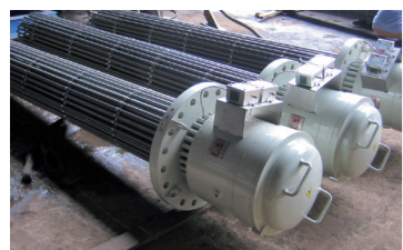
Сборочный пункт 3,2 МВт, 53 м3/час нагреватель воды/сырой нефти 82 °C и взрывоопасная зона 51 бар
