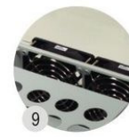
9 8025 ball bearing fan x 2 (central)
