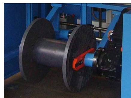
Fig. 4 UMROL 1000 AUF drum reception via spindle sleeves
