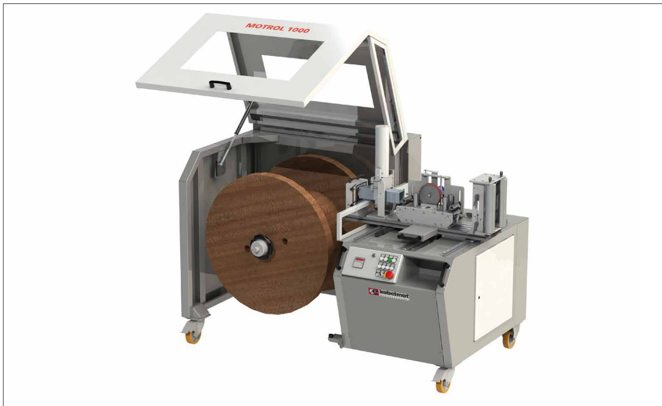
Fig. 1 MOTROL® 1000 AUF with opened protective cover
