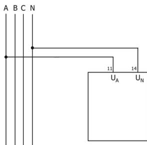
Подключение вольтметра переменного тока и частотомера
