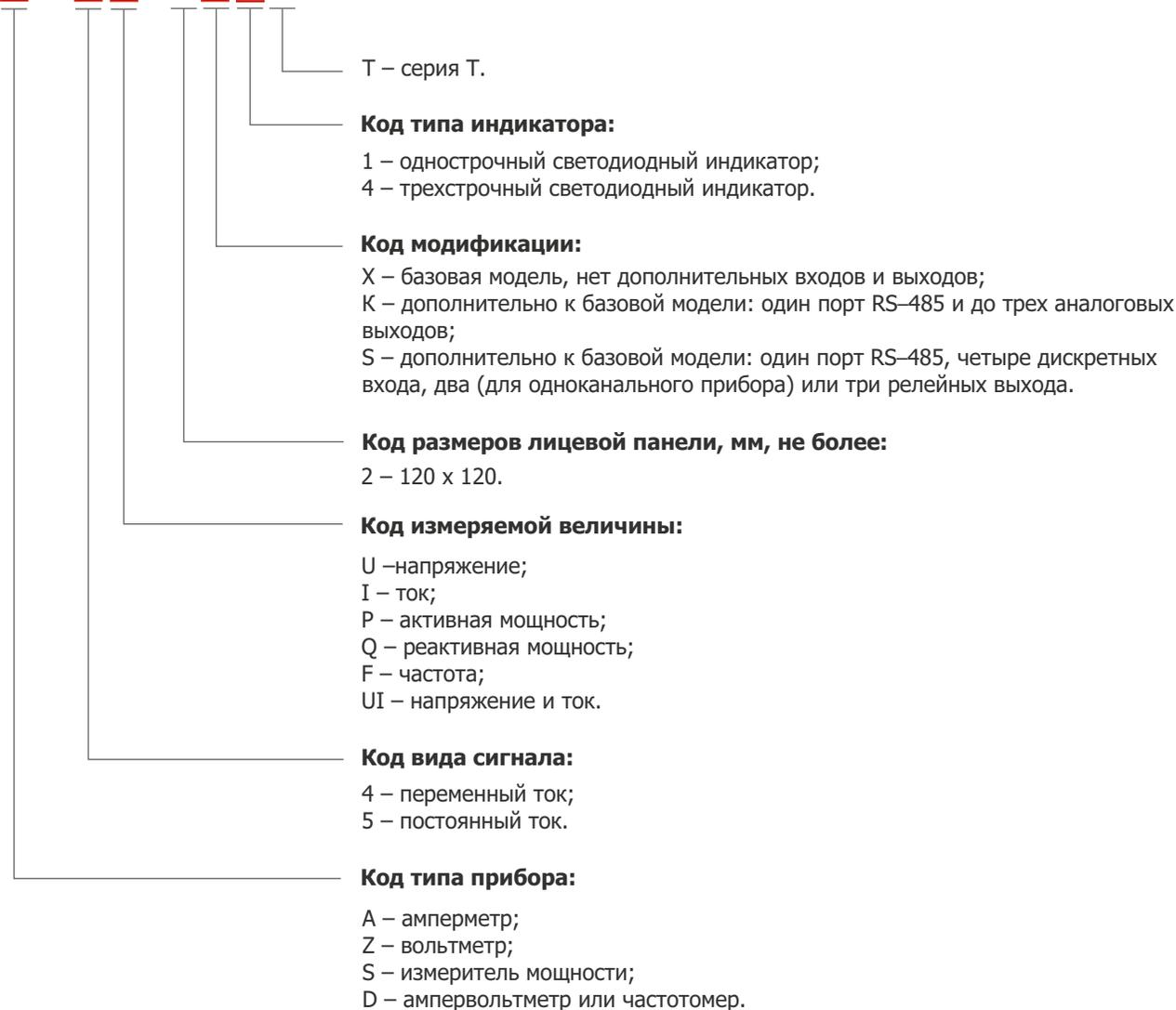
**Примечание:** название прибора состоит из ряда символов, каждый из которых кодирует ту или иную функцию изделия. Для правильного выбора модификации прибора обращайтесь к таблице 1.
