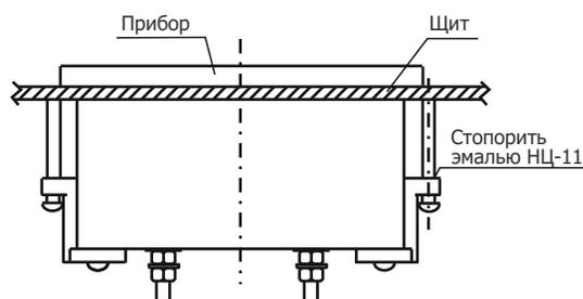
Схема 3. Схема крепления приборов ЭА72, ЭВ72, ЭА96, ЭВ96, ЭА120У, ЭВ120У.
