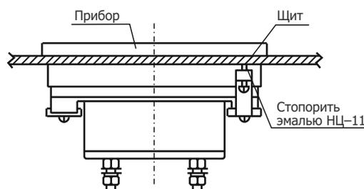
Схема 2. Способ крепления приборов ЭА120Ц, ЭВ120Ц.
