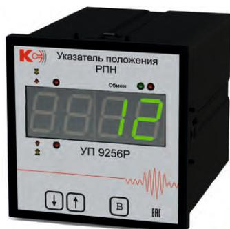
Указатели положения предназначены для преобразования сигнала датчика положения привода РПН трансформатора в цифровой код, отображения номера положения переключателя на отсчетном устройстве с последующим преобразованием в унифицированный выходной аналоговый сигнал, передачи результатов преобразования посредством интерфейса RS-485 (протокол Modbus RTU).
