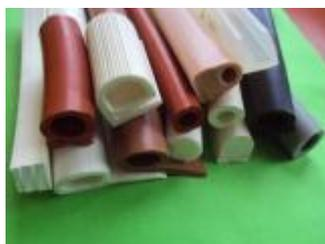
**Силиконовые шнуры** круглого, прямоугольного, квадратного сечений различных размеров изготовлены из силиконовой резины, термостойкость от -60 до +280 С, устойчивы к воздействию морской и пресной воды (в том числе кипящей), растворов солей, спиртов, фенолов, минеральных масел, кислот и щелочей, перекиси водорода, озона, вакуума, воздействию радиации, к электрическим полям, электрической короне и дуге.
