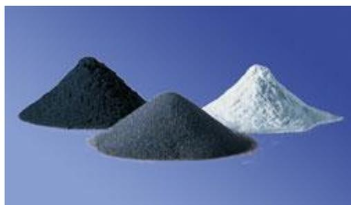
**Микропорошки нитридов алюминия, бора и оксинитрид алюминия** производимые нашим предприятием на самом современном оборудовании и жестким методам контроля, благодаря высокому качеству нашли широкое применение в таких отраслях промышленности как электроника, цветная и черная металлургия, авиация, изготовление элементов спецтехники. Керамические материалы получаемые из
