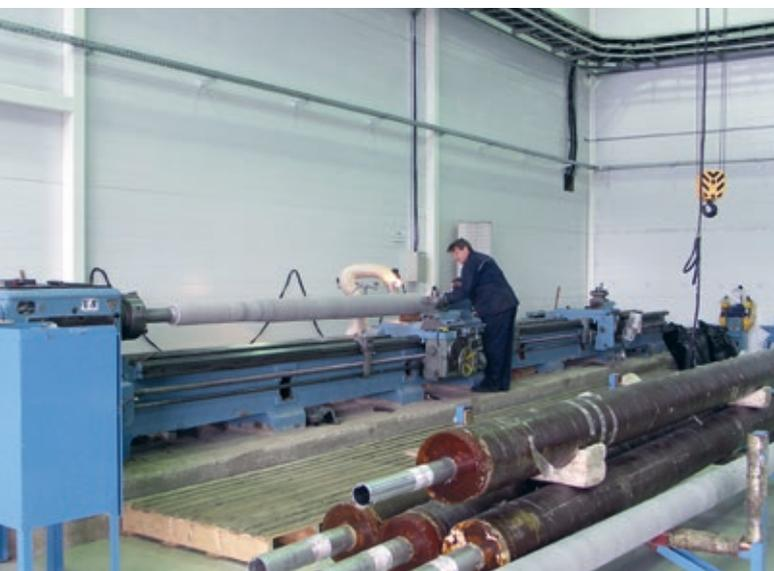
Рис. 10. Токарная обработка RIP-изоляции 220 кВ на заводе «Изолятор»
