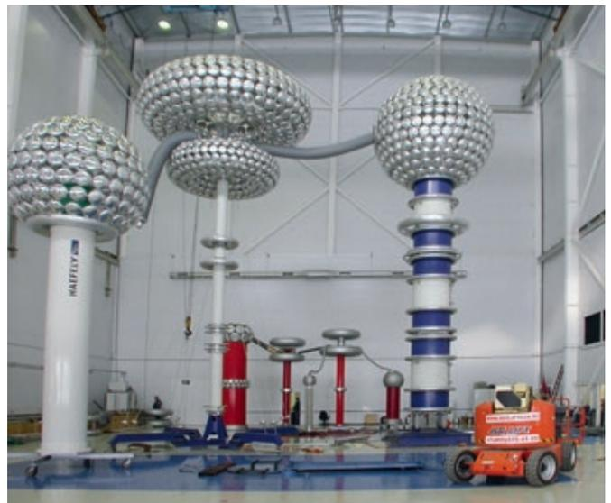
Испытательный центр завода «Изолятор»
