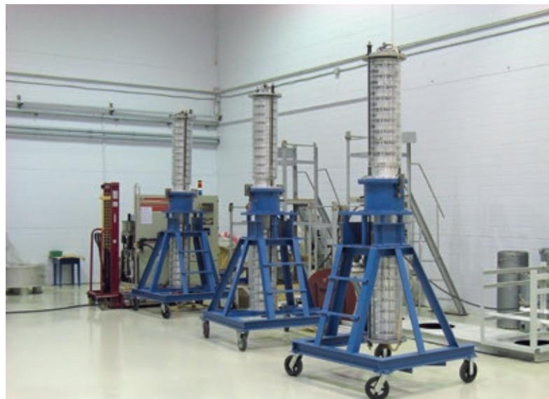
Рис. 13. Прямое литье силиконовой резины на твердую RIP-изоляция на заводе «Изолятор»
