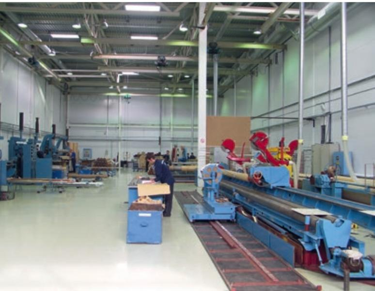
Рис. 8. Участок намотки бумажной изоляции 35–750 кВ на заводе «Изолятор»
