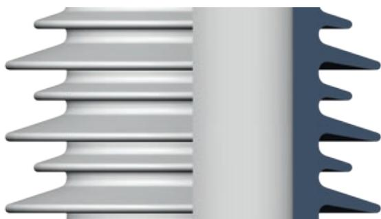
Рис. 4. Профиль фарфоровой покрышки
