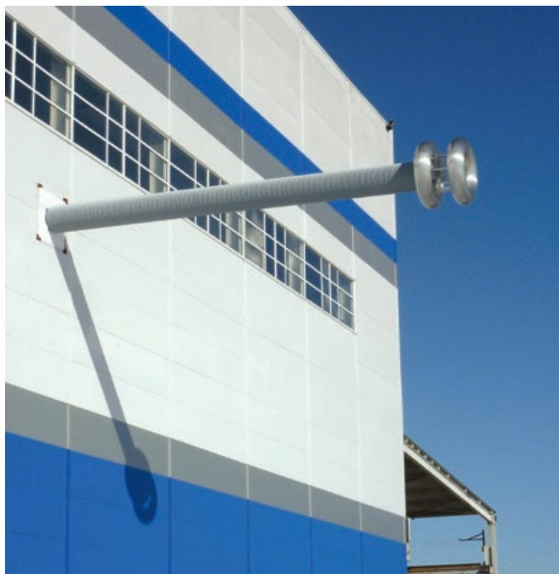
*Линейный ввод 820 кВ постоянного тока в испытательном центре компании «Изолятор»*
