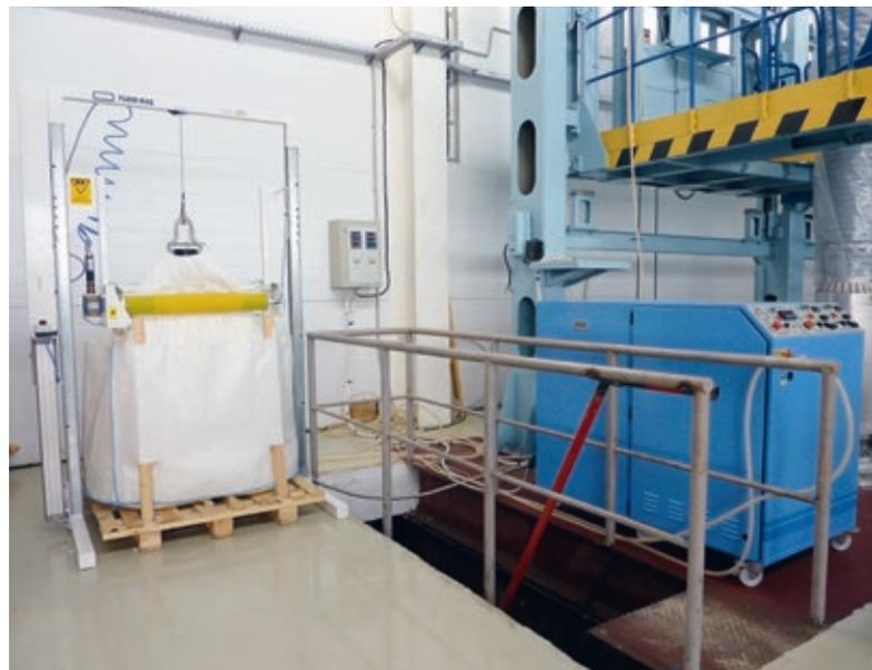
Рис. 12. Установка для дегазации и дозирования компрессионного геля на заводе «Изолятор»
