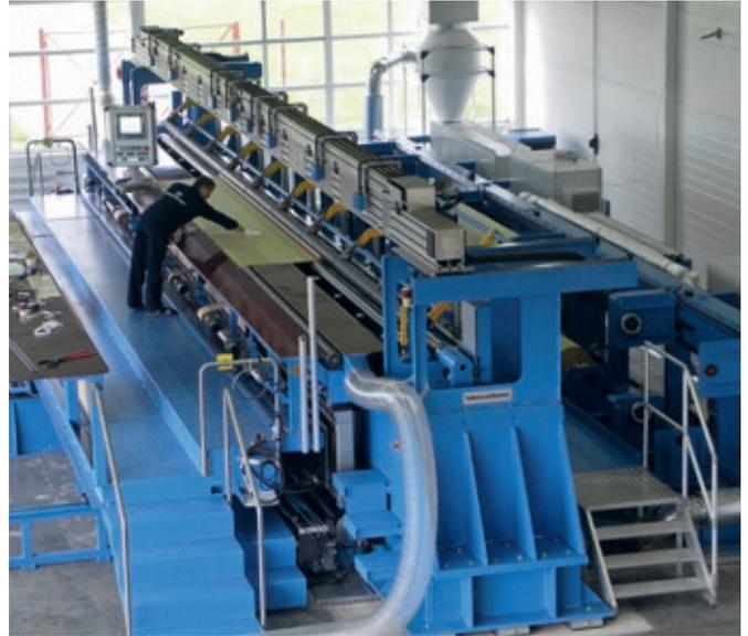
Изготовление основной изоляции вводов на заводе «Изолятор»
