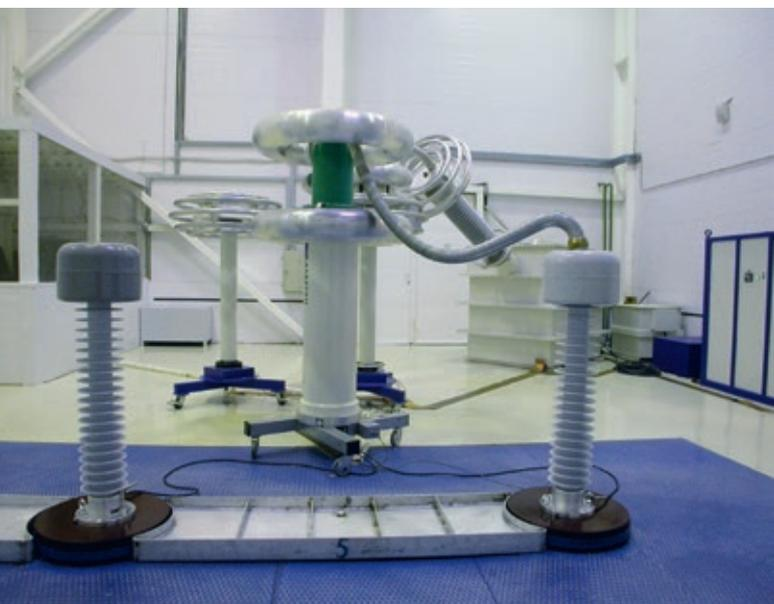
Рис. 15. Электрические испытания вводов 110 кВ на заводе «Изолятор»
