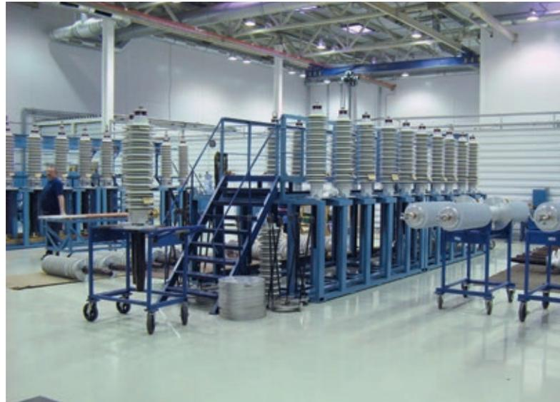
Рис. 11. Участок сборки вводов 35-150 кВ на заводе «Изолятор»
