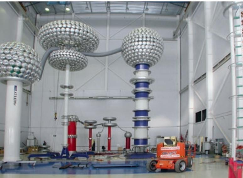
Рис. 14. Участок испытаний вводов 220–1150 кВ на заводе «Изолятор»
