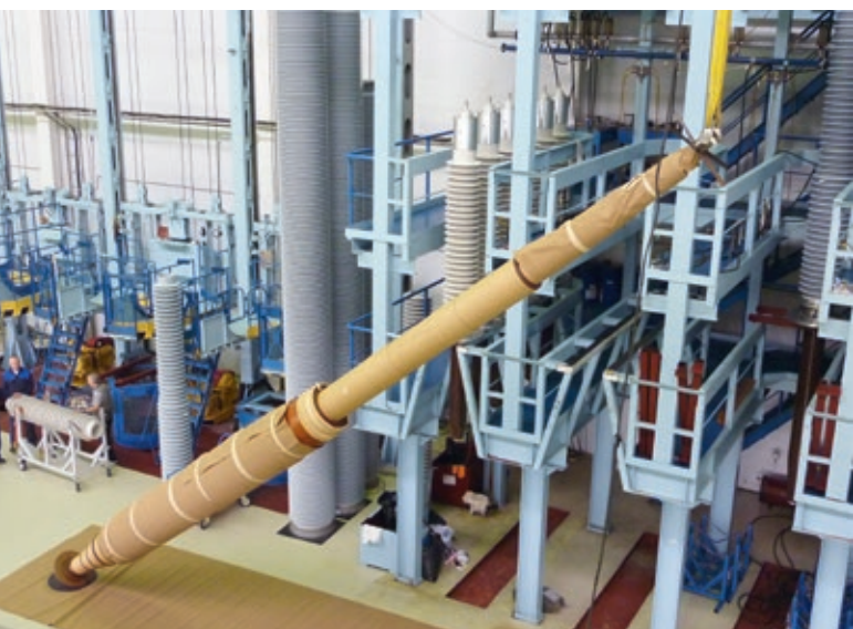
Рис. 33. Сборка ввода на напряжение 1150 кВ на заводе «Изолятор»
