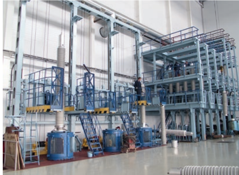
Рис. 20. Вводы 500 и 330 кВ на сборочных стойках на заводе «Изолятор»
