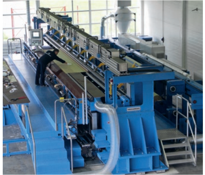
Изготовление основной изоляции вводов на заводе «Изолятор»
