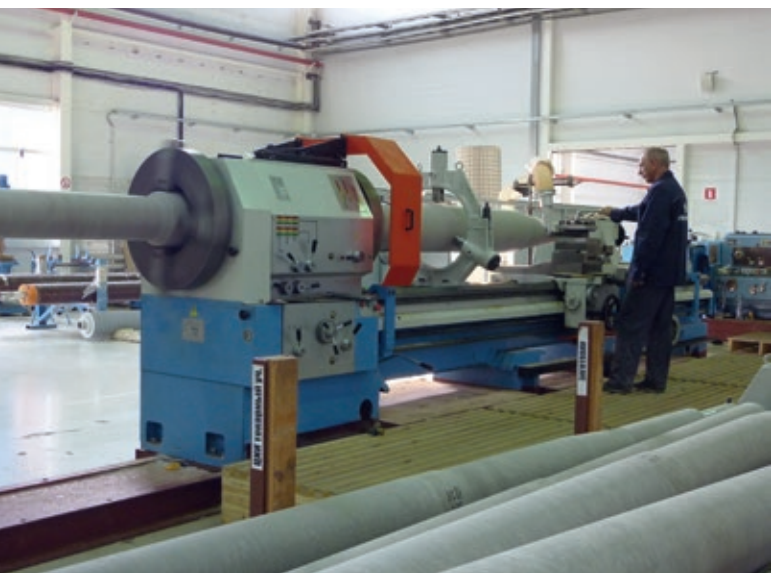
Рис. 19. Токарная обработка RIP-изоляции 500 кВ на заводе «Изолятор»
