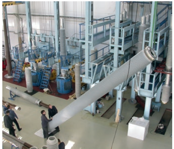
Сборка вводов на сверхвысокие классы напряжения на заводе «Изолятор»
