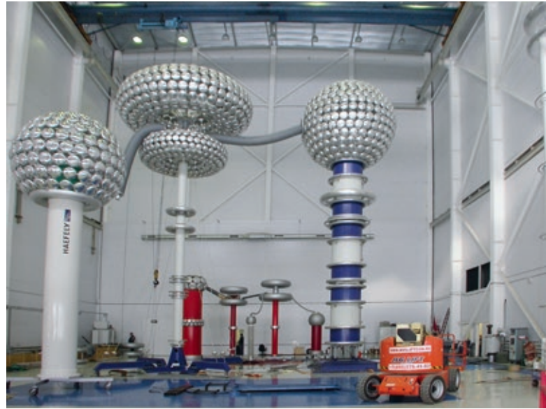
Рис. 34. Участок испытаний вводов 220–1150 кВ на заводе «Изолятор»
