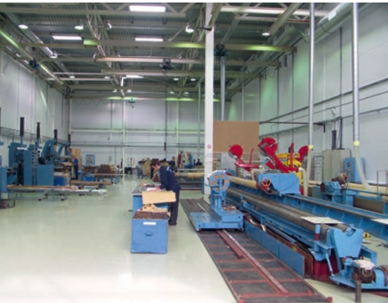
Рис. 17. Участок намотки бумажной изоляции 35–750 кВ на заводе «Изолятор»
