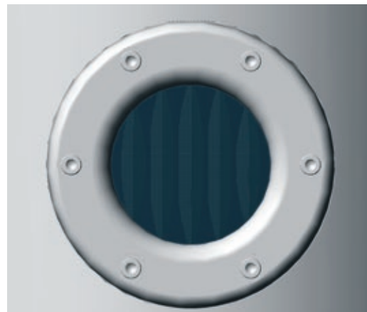
Рис. 7. Нормальный уровень жидкого наполнителя
