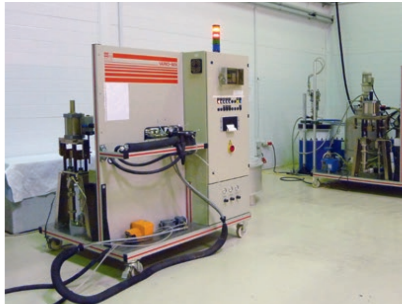
Рис. 22. Литьевые машины Hilger и Kern для изготовления внешней полимерной изоляции на заводе «Изолятор»
