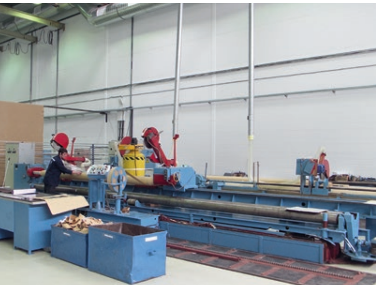
Рис. 31. Намотка бумажной изоляции 220 кВ лентой на заводе «Изолятор»
