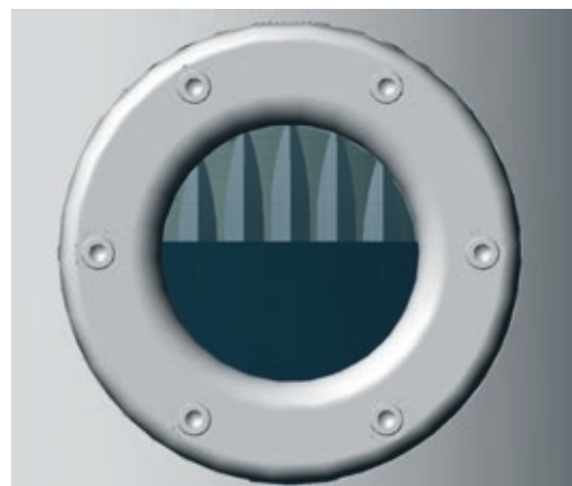
Рис. 8. Пониженный уровень жидкого наполнителя
